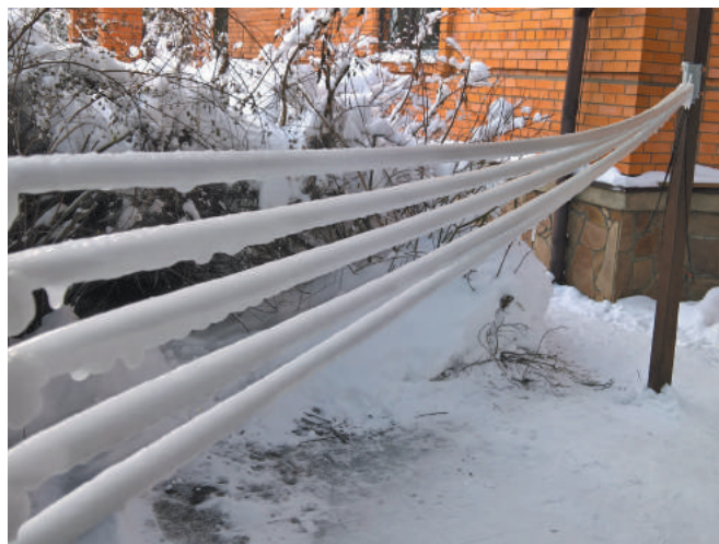
Рис.3. Обледенение тонких дроп-кабелей: кабели 2×4 мм, со льдом – 20 мм (эксперимент)
